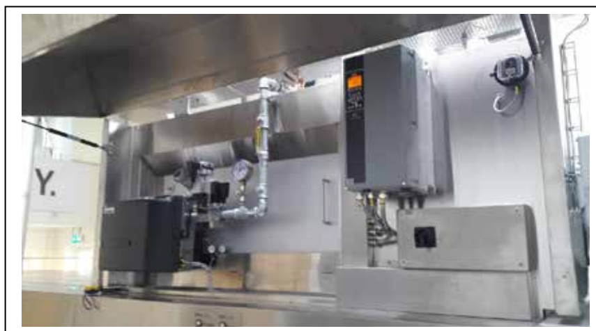
Рис. 5. Нагрівальний модуль дослідної низькотемпературної печі на датській фабриці НААС-МЕЙНСКЕ
